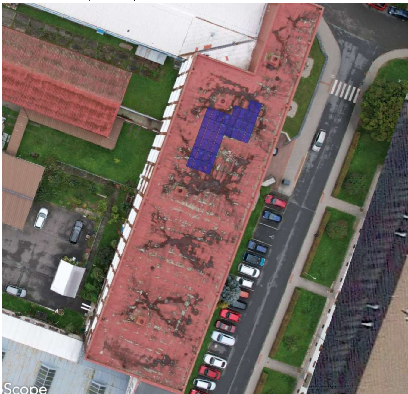
Obrázek č. 4.9.4.1: Rozložení panelů/Plocha pro umístění FVE
